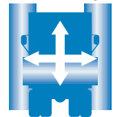
Dreibürstenwäsche mit konturenfolgender Dachbürste und mittenüberdeckenden Seitenbürsten
