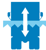
Hochdruckwäsche mit dem konturfolgenden und drehbaren Hochdruckbogen zur Fahrwerks- und Räderreinigung
